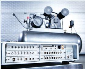
**Simcenter SCADAS Recorder**系统是便携式、独立于计算机的智能数据记录系统。无论是试验室还是现场试验,均能通过平板电脑无线连接至Simcenter SCADAS Recorder系统,进行采集控制。
