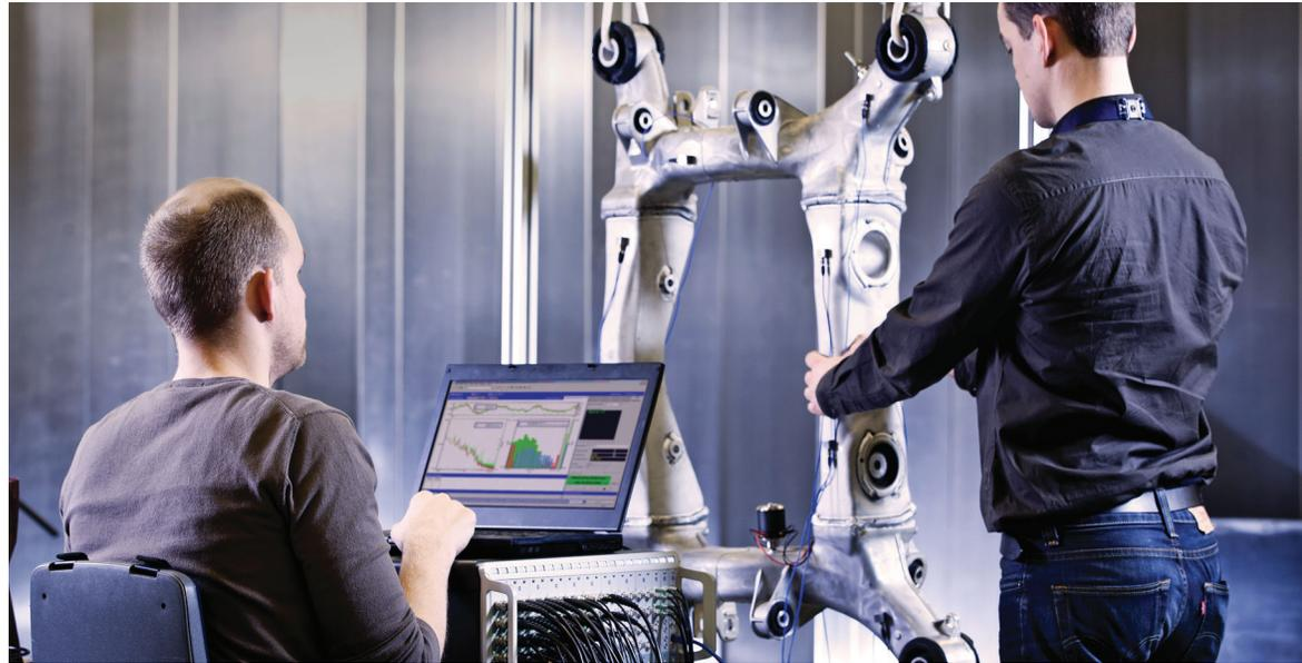
Simcenter Testlab 结构动力学试验是一套全面的结构动力学和模态试验分析软件。表征结构的结构动力学特性在过去是一个漫长而复杂的过程,涉及耗时的参数设置以及大量的重复性试验。现在情况不再是这样了。将 Simcenter Testlab 结构动力学试验软件和 Simcenter SCADAS 数采系统相结合,可以轻松地执行大型结构的模态试验,整个试验周期只需要几个小时,而不再需要耗费好几天的时间。
